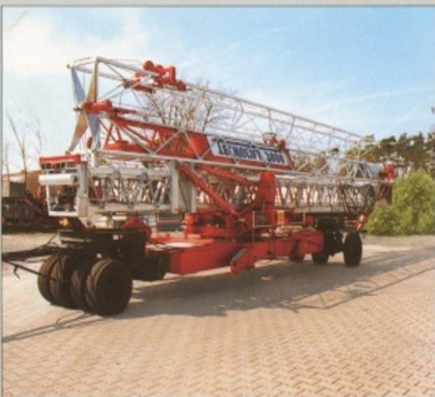
Die dank des **patentierten Montagesystems** besonders einfache Montage und Demontage erfolgt über die serienmäßige Kabel- oder die optionale Funkfernsteuerung.
