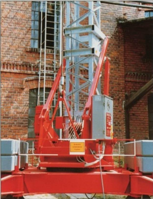
Ein moderner City-Schnellmontagekran der mit einem Drehradius von nur 0,9 m nicht über den Ballast bzw. die nur 3,0 m breite Abstützung schwenkt und sich somit besonders für Aufstockungen, An- und Umbauten sowie Renovierungs- und Sanierungseinsätze in engen Innenstadtbaustellen eignet.
