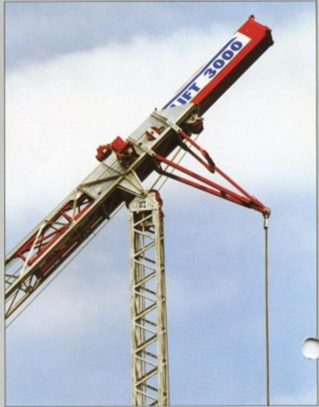
Während dem Teleskopiervorgang von Ober- und Unterturm durchläuft der Gegenballast den gesamten hinteren Ausleger, bis er seine Endstellung erreicht.
